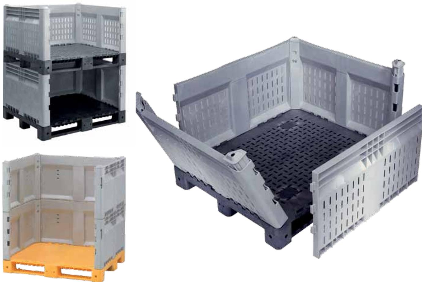
Das KitBin System basiert immer auf einer System-Kunststoffpalette mit Krallen am äussersten Rand. In diese Krallen können Seitenwände eingehängt werden, welche untereinander verriegelt und in extrem kurzer Zeit zu einem Behälter in Wunschkhöhe aufgebaut werden können.
